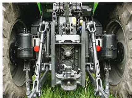
Der tiefe Schlitten für das Zugmaul ermöglicht einen problemlosen Betrieb von Maschinen mit Untenanhängung.
