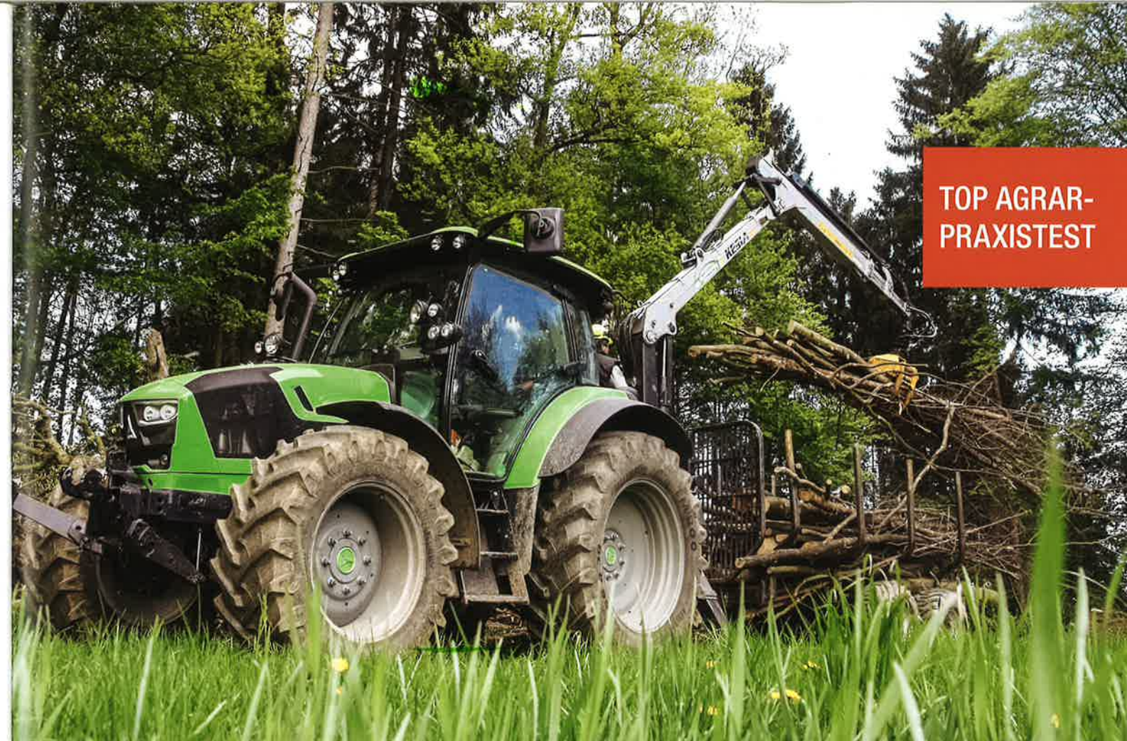
Auch bei Forstarbeiten macht der Traktor eine gute Figur. Die Hydraulikpumpe liefert 60 l/min bei 1600 U/min Motordrehzahl.
