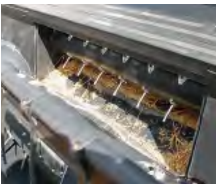
Das „Extra-Feeding“-System bringt laut Deutz-Fahr 10 % mehr Durchsatz, weil diese Trommel für einen gleichmäßigen Einzug sorgt.
