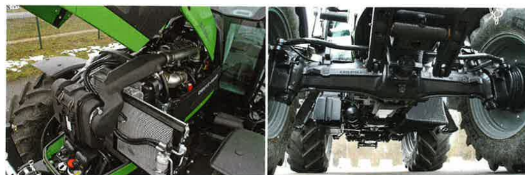
Zur Reinigung der Kühler wird lediglich ein Element nach links und ein Sieb nach rechts hinausgezogen. Das Luftfilterpaket befindet sich gut zugänglich ganz vorn. Die unteren Seitenteile der Motorraumabdeckung lassen sich ebenfalls entfernen. Das leistungsverzweigte SDF-Getriebe kommt aus dem Vorgänger Agrofarm TTV. Jedes der Räder verfügt über eine eigene Scheibenbremse. Die Vorderachse ist gefedert.
